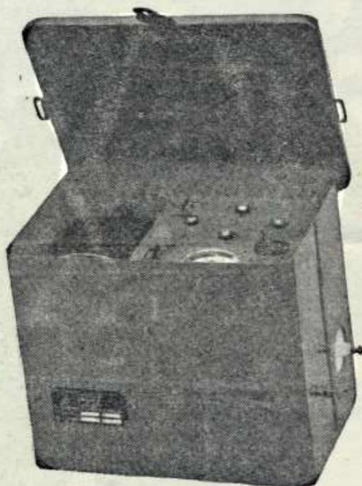
Cet appareil, alimenté par une batterie de 6 volts 24 ampères-heure, possède un chargeur incorporé qui permet, sans aucun démontage, avec une simple prise de courant, de conserver la charge de la batterie à un niveau normal qui est indiqué par un voltmètre de contrôle, par la manœuvre d'un bouton-flèche.
