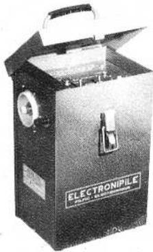
Le FILPIC ELECTRONPILE est un modèle portatif alimenté par pile sèche, non rechargeable, 9 Volts 90 Ampères-heure; son rupteur est tout électronique avec production d'impulsions courtes par décharges de condensateur. Un convertisseur à découpage et régulation permet de maintenir l'efficacité et le rendement à de hauts niveaux jusqu'à usure complète de la pile.
