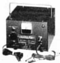
C'est le gros chargeur, idéal à la ferme pour les batteries de tracteurs diésel et les voitures; il est protégé par un disjoncteur et son débit, autorégulé est indiqué par un ampèremètre; **il peut servir aussi pour aider au démarrage.** Courant de charge 10 Ampères en 6 Volts, 8 Ampères en 12 Volts.
