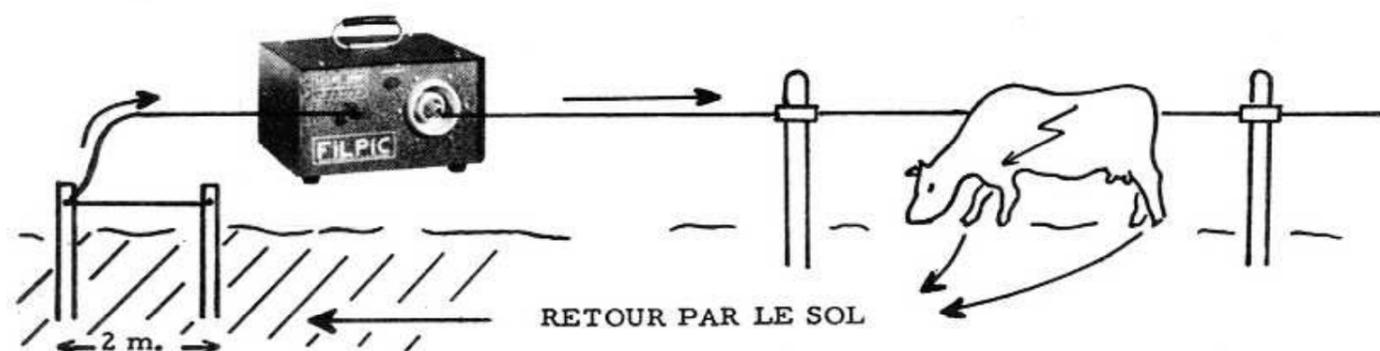
Pour qu'un courant électrique puisse produire un effet ou une douleur, il doit pouvoir SORTIR par une des bornes (borne "Clôture") du générateur, ÊTRE CONDUIT (fil sur isolateur) au récepteur (ici, c'est la vache), TRAVERSER le récepteur et REVENIR par le sol, qui se comporte ici comme un assez bon conducteur de l'électricité, aux PRISES DE TERRE qui le collectent pour le conduire à la borne "Terre" et réaliser ainsi le CIRCUIT FERMÉ, ALLER plus RETOUR nécessaire au passage du courant.
