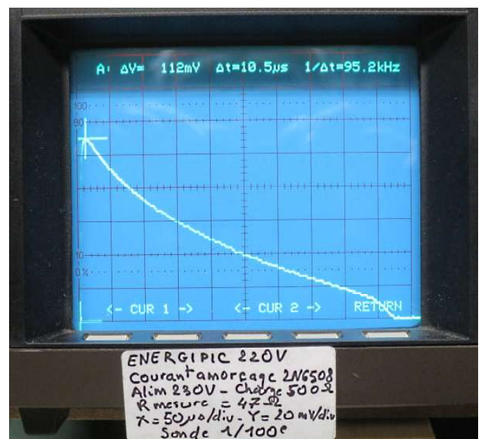
Courant d'amorçage du thyristor 10,5 \mu\text{s} après l'amorçage du diac, le courant entrant dans la gachette du thyristor est de 238 mA (tension sur la résistance de 47 Ohms)
